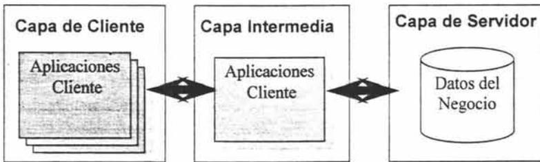
Figura 16: Estructura de Sistema Three-Tier
