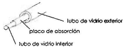
DETALLE DE TUBERÍA DE TERMOSIFÓN
