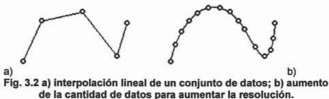
Fig. 3.2 a) interpolación lineal de un conjunto de datos; b) aumento de la cantidad de datos para aumentar la resolución.
