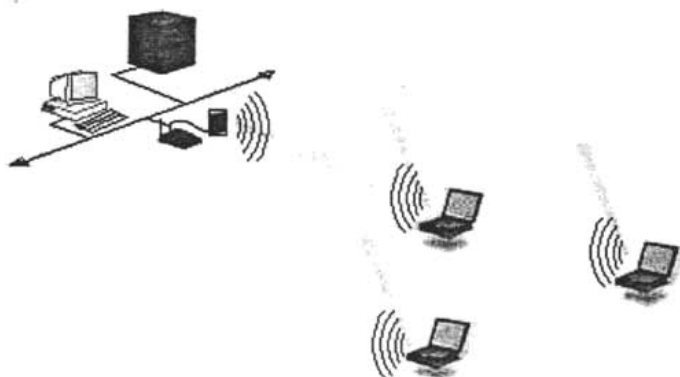
Fig. 2.10 Modo Infraestructura (BSS)
