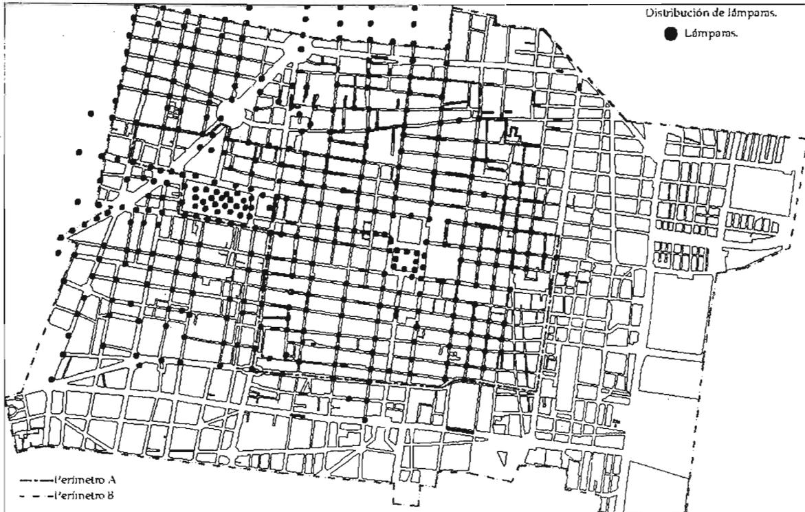
Plano con información de la distribución de las luminarias en 1902, y que a diferencia de la distribución del gas (el gas junto con la grasa se siguieron utilizando sobre todo en el oriente de la ciudad) la iluminación con energía eléctrica se dirige hacia el poniente, tomando el eje que forma el Paseo de la Reforma y que llevará hacia las nuevas colonias, enmarcando el paso hacia el castillo de Chapultepec.
