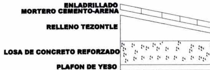
El relleno promedio se obtiene considerando una pendiente del 2% desde el punto más alejado a la bajada de aguas pluviales (B.A.P.) indicada en la planta de azotea; dicha distancia es de 7.20 m que al multiplicarla por el 2% y dividiendo entre dos para obtener el promedio, obtenemos un desnivel de 7.20 cm. Más cinco que se tienen como relleno mínimo en la B.A.P., lo que nos da como resultado 12 cm. Se propone un espesor igual a 12 cm. para losa de concreto reforzado.
