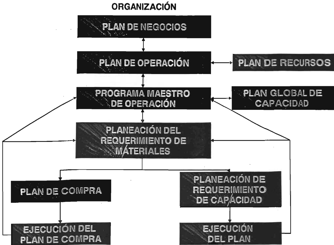
Fig. 4.- La programación y ordenamiento, permite planear y programar los requerimientos de los materiales para el abasto de refacciones y componentes que soportan las reparaciones que ejecuta el mantenimiento.
