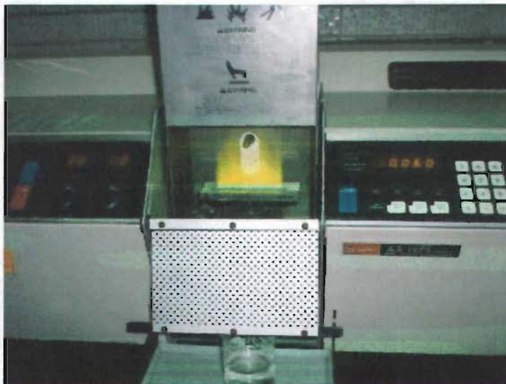
Foto 6-A. Detalle de la unidad de espectrofotometría con la llama de flujo laminar, nebulizador de la muestra y la lente móvil para la lectura de la absorción.
