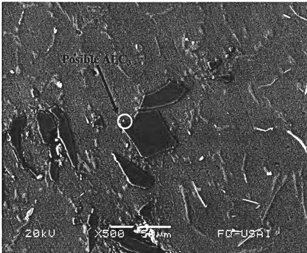
Figura 3. Microestructura de un compuesto con 15 % SiC, donde en el círculo y marcado con una flecha se observa posiblemente la formación de  $Al_4C_3$ .
