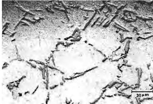
Figura 18. Microestructura de una aleación A-356 sin reforzar.
