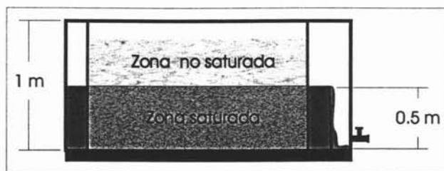
Figura 3.2. Altura máxima del modelo experimental en relación con las zonas de estudio
