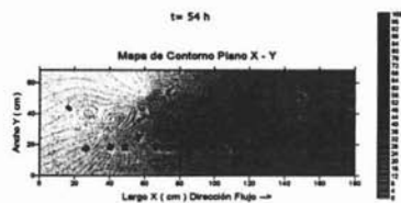
Figura 5. 17. Mapas de contorno y superficie obtenidos durante la prueba de funcionamiento del modelo experimental utilizando NaCl como trazador
