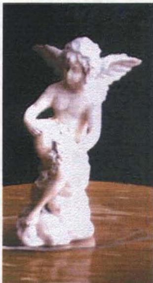
Figuras de resina époxica después del decapado alcalino, este sustrato se trato primero con ácido crómico.
