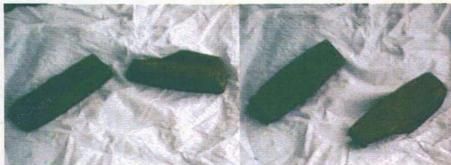
Esta es la primera figura que se logró recubrir totalmente por depositación química, el recubrimiento sigue siendo opaco.
