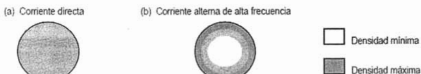
Fig. 4.9 Densidades de corriente en un mismo conductor, (a) a corriente directa y (b) a corriente de alta frecuencia.
