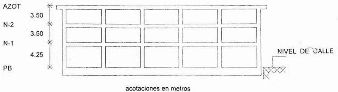
Fig 3.2 Corte longitudinal del modelo 3NIV, casos A y B
