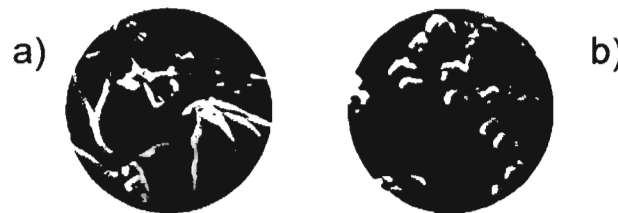
Figura 1. Estructura de a) Calcita y b) Aragonita.
