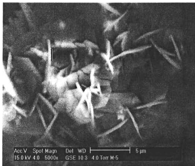
Figura 44. SEM de la muestra a mayores aumentos, incrustación de \text{CaCO}_3 en su forma de la calcita.
