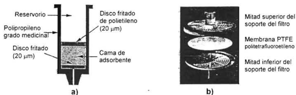
Figura 3.2 Dispositivos para la EFS en diferido. a) Cartucho desechable (formato de barril de jeringa) b) Disco con soporte
