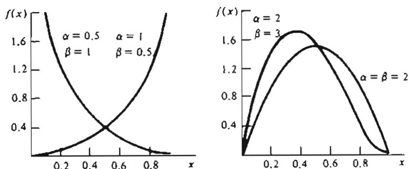
FIGURA 2.10 Gráfica de la función de densidad beta para distintos valores de  $\alpha$  y  $\beta$ .<sup>37</sup>
