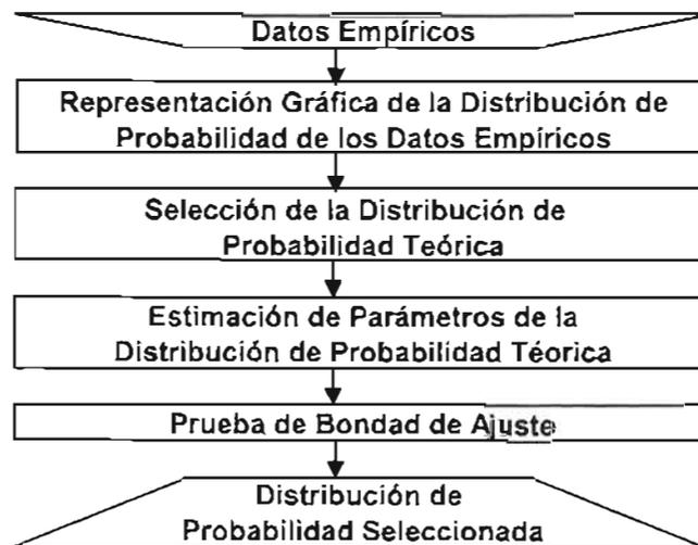
FIGURA 3.1 Algoritmo para la Estimación de la Distribución de Probabilidad para Datos Empíricos.<sup>2</sup>
