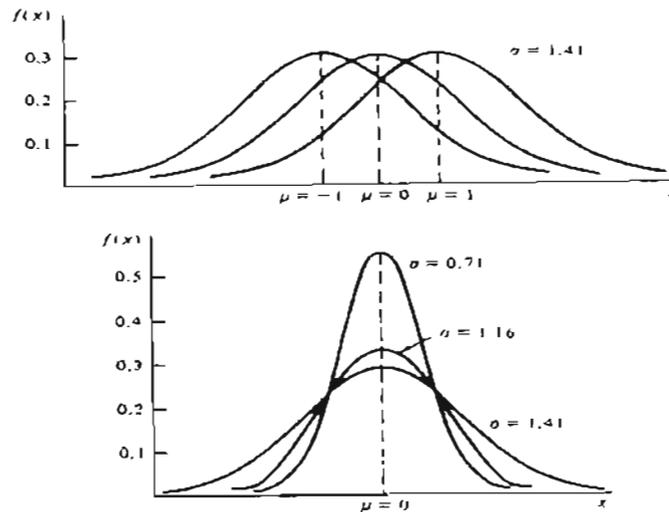
FIGURA 2.4 Gráficas de la función de densidad normal para diferentes valores de  $\mu$  y  $\sigma$ .<sup>22</sup>
