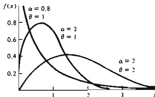
FIGURA 2.8 Gráficas de la función de densidad de Weibull para distintos valores de  $\alpha$  y  $\theta$ .<sup>32</sup>
