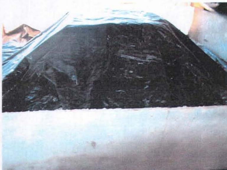
Cubierta de plástico para evitar volatilización de compuestos y agua
