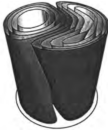
Figura 5.7: Isosuperficies de velocidad vertical para la zona central 0.25 < z^* < 0.75 , Ra=7.5 \times 10^5 .
