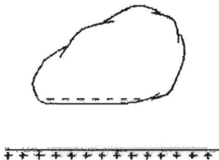
Figura 2.2. La parte inferior de la nube, con carga negativa, induce carga positiva en la superficie de suelo subyacente.
