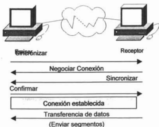
Figura 3-11 Conexión típica entre emisor y receptor
