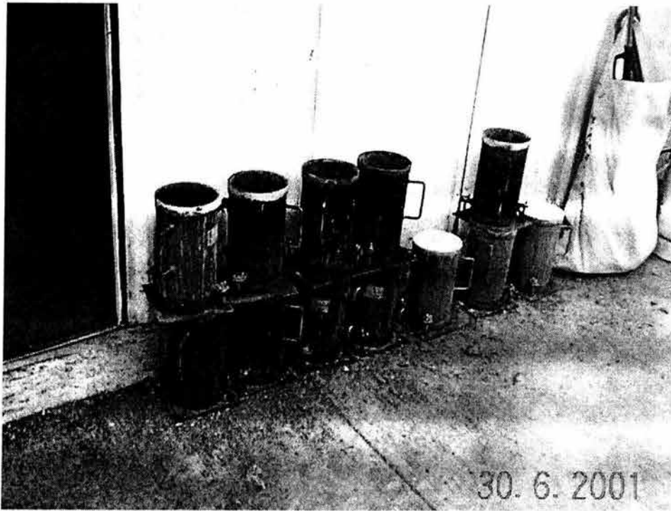
Fig. 6.4 Moldes Para Prueba de Resistencia de Concreto
