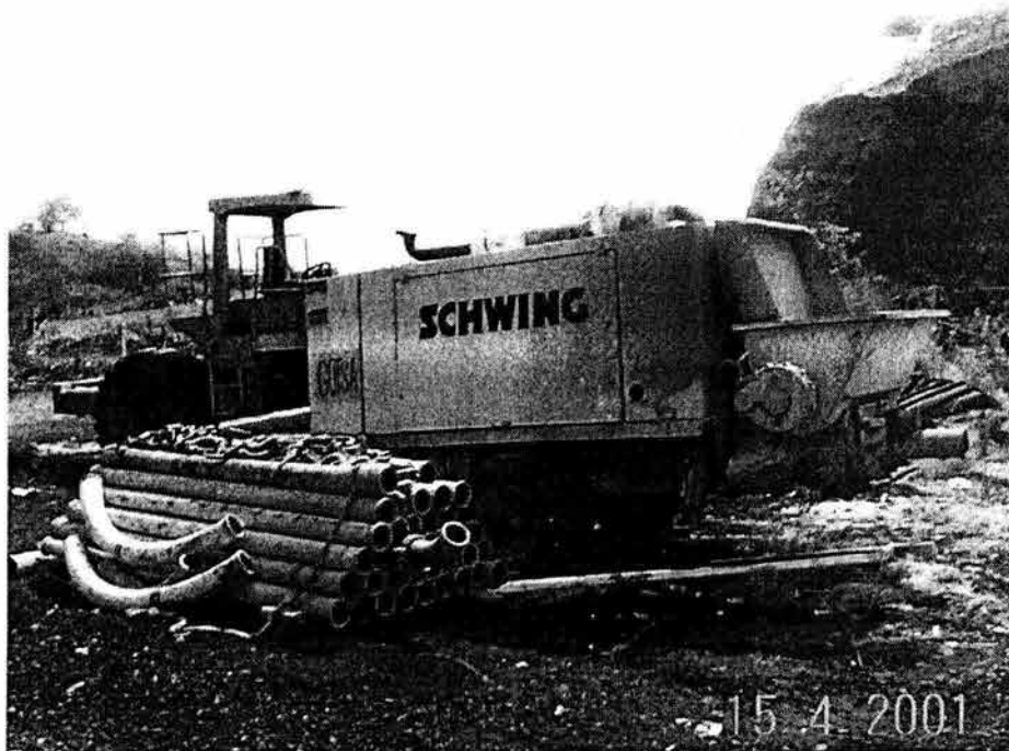
Fig. 3.2 Bomba de Concreto fija y tubería
