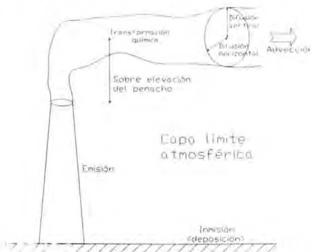
Figura 1.2. Fenómenos presentes en el transporte de un penacho gaseoso en la atmósfera.
