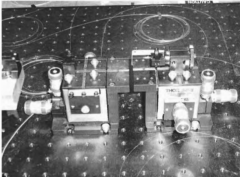
FIGURA 3-23 Dispositivo para generar torsión en la fibra en el segundo experimento. Un punto fijo donde se coloque la fibra (superficie plana del lado izquierdo) fija la fibra para que el otro lado pueda inducir torsión de manera controlada (lado derecho).
