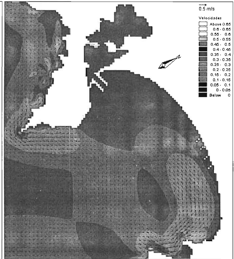
Figura 3. 45 Patrón de corrientes litorales, para la dirección S60^{\circ}W , altura de ola H = 1.517 m, Período de ola T = 7.32 s, para la alternativa 2.
