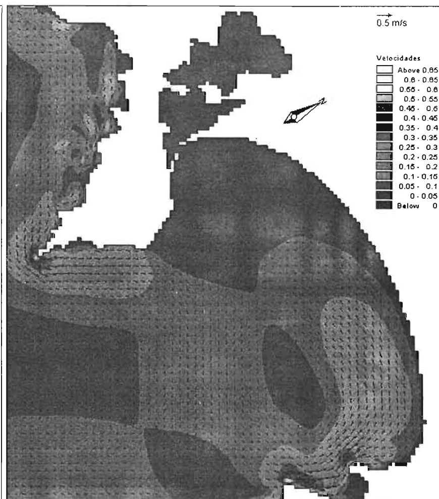
Figura 3. 33 Patrón de corrientes litorales, para la dirección S60^\circ W , altura de ola H = 1.517 m, Período de ola T = 7.32 s, en condiciones actuales.
