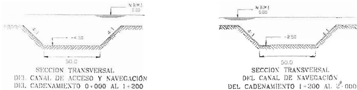
Figura 5. 3 Sección geométrica del canal de navegación propuesto.
