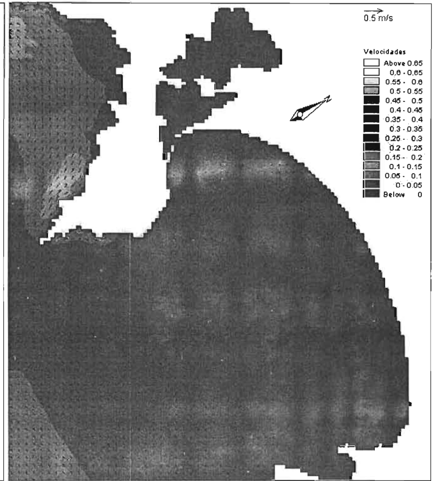
Figura 3. 37 Patrón de corrientes litorales, para la dirección S60°E, altura de ola H = 1.836 m, Período de ola T = 8.01 s, en condiciones actuales.
