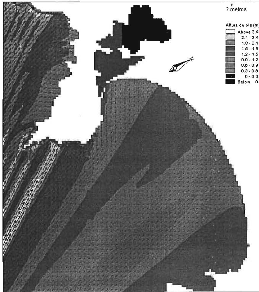
Figura 3. 7 Distribución espacial y en planta del oleaje normal representada por vectores y curvas de igual altura de olas, para la dirección S30°E, altura de ola H = 2.052 m, periodo de ola T = 8.65 s, en condiciones actuales.
