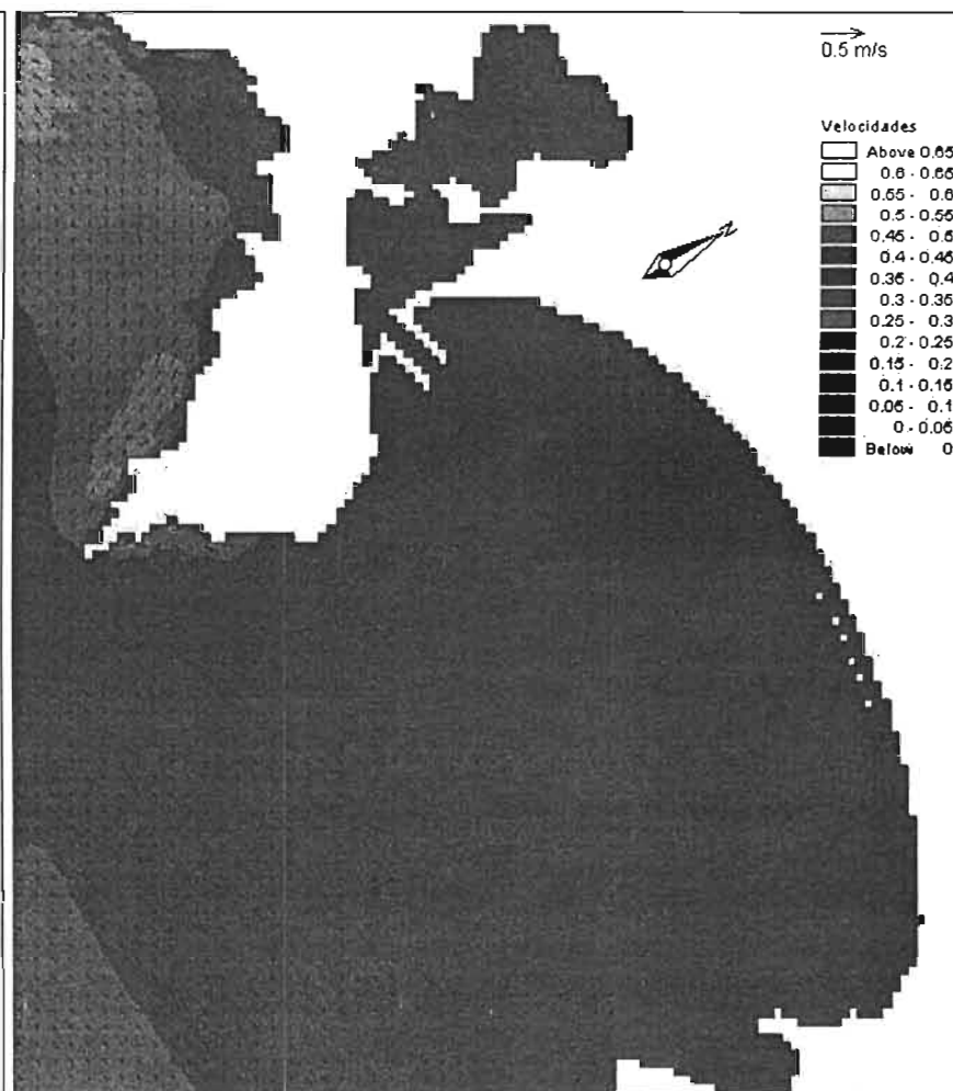
Figura 3. 43 Patrón de corrientes litorales, para la dirección S60°E, altura de ola H = 1.836 m, Periodo de ola T = 8.01 s, para la alternativa 1.
