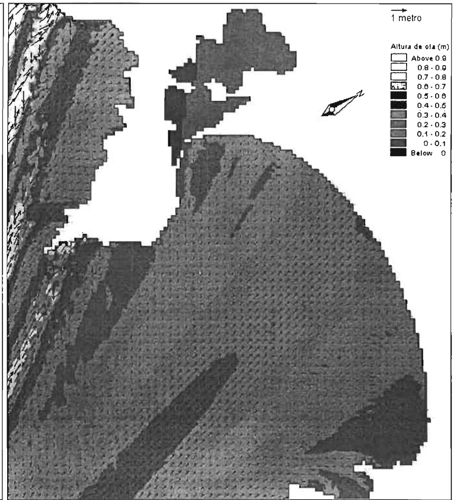
Figura 3. 8 Distribución espacial y en planta del oleaje normal representada por vectores y curvas de igual altura de olas, para la dirección S60°E, altura de ola H = 1.836 m, periodo de ola T = 8.01 s, en condiciones actuales.
