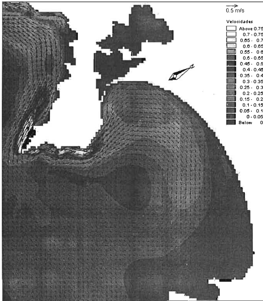
Figura 3. 36 Patrón de corrientes litorales, para la dirección S30°E, altura de ola H = 2.052 m, Período de ola T = 8.65 s, en condiciones actuales.
