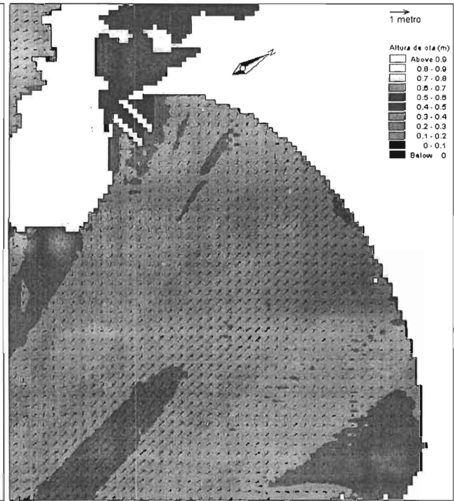
Figura 3. 26 Distribución espacial y en planta del oleaje normal representada por vectores y curvas de igual altura de olas, para la dirección S60°E, altura de ola H = 1.836 m, período de ola T = 8.01 s, con la presencia de la alternativa 2.
