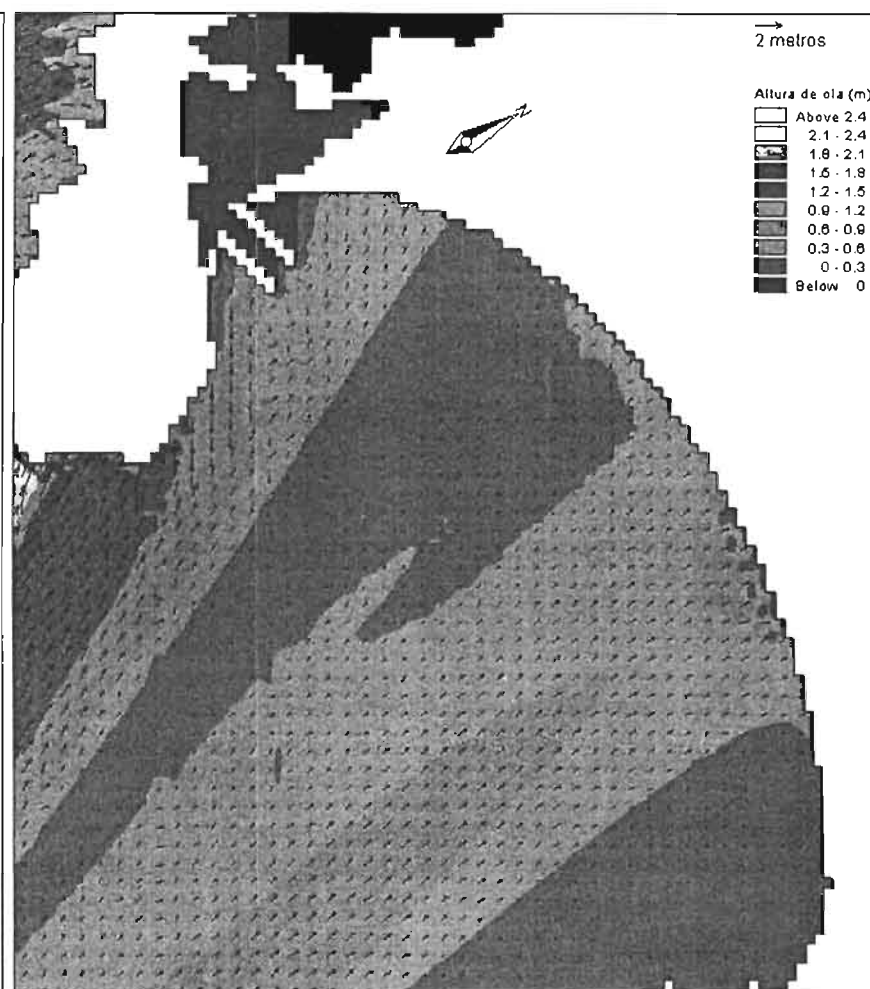
Figura 3. 16 Distribución espacial y en planta del oleaje normal representada por vectores y curvas de igual altura de olas, para la dirección S30^{\circ}E , altura de ola H = 2.052 m, periodo de ola T = 8.65 s, con la presencia de la alternativa 1.
