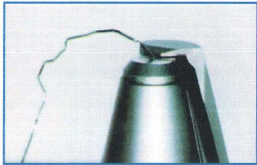
Fig. 50: Creación de los arcos individuales por medio del ordenador Module lingual Orthomate
