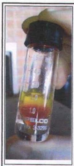
*Fig. 18.* La extracción se realiza en el mismo vial donde se realizó la hidrólisis.
