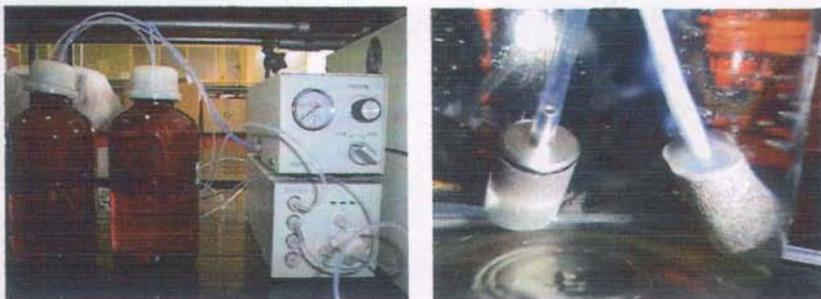
Fig. 5. En la imagen de la izquierda se muestran los contenedores de la fase móvil, así como el módulo de mezclado a baja presión y el de desgasificación, mientras que a la derecha se muestran los filtros de acero inoxidable.
