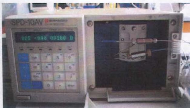
Fig. 9. Detector UV-Vis de longitud de onda variable Shimadzu®, se observa la celda de flujo (lo que se observa a la derecha).
