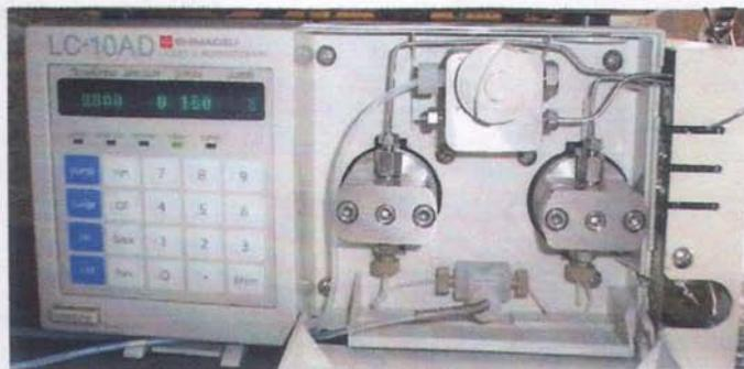
Fig. 6. En esta imagen se puede apreciar el módulo de la bomba recíprocante, con el controlador de flujo, así como las “cabezas” de la bomba donde se encuentran los pistones.
