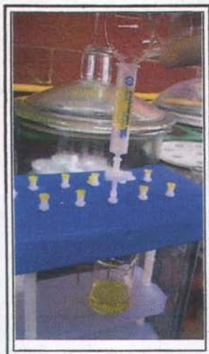
Fig. 20. Columna de purificación conectada a vacío.
