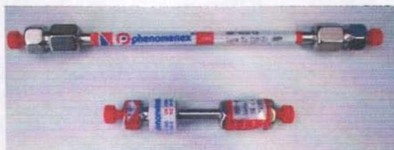
Fig. 8. Columnas analíticas de longitud 15cm y 5cm. Phenomex®.
