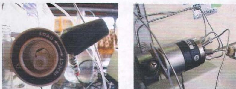
Fig. 7. El rotor de la válvula de seis pasos (izq.) y el “cuerpo” de la válvula (der.) donde se puede observar el “loop” y las conexiones de la tubería hacia columna, desechos y la que transporta a la fase móvil
