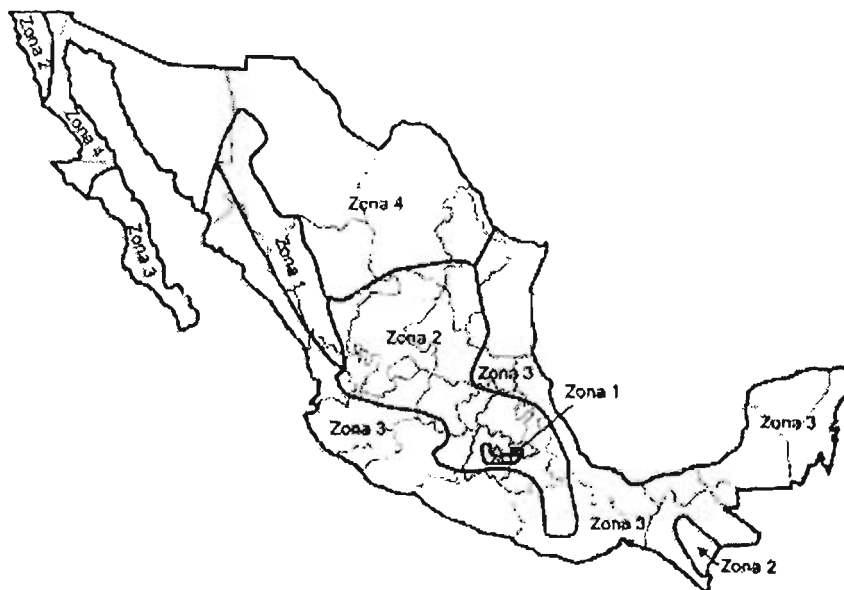
FIGURA 1.8 Regiones geográficas para la utilización de asfaltos clasificados según su viscosidad dinámica a 60°C (ver tabla 8).
