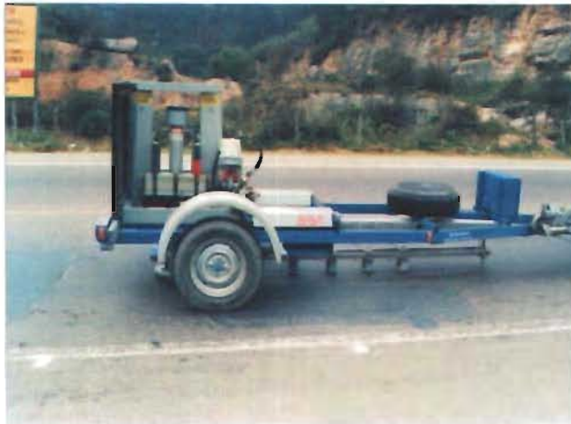
FIGURA 3.7 y 3.8. Equipo para medir las deflexiones bajo carga de impacto, y la aplicación de carga del equipo HWD-8081 al pavimento y la medición de los módulos elásticos mediante sensores. (4)
