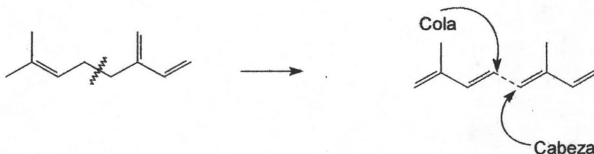
Figura 2.- Unión regular de isopreno cabeza-cola.
