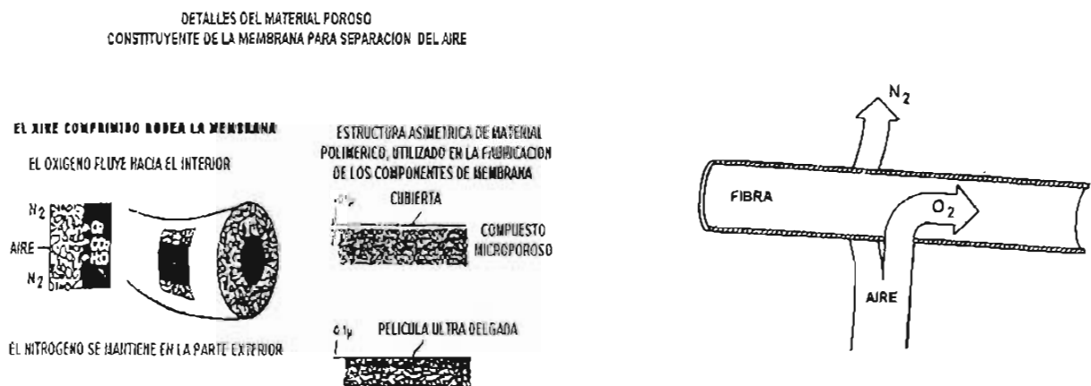
Figura 2.12. Esquema del material de las membranas; Cía. Nitropet Praxair.
