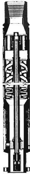
Corte interior de una bomba sumergible (Cortesía de Centrilift) FIGURA No. II.3.2.1/1 BOMBAS CENTRÍFUGAS BEC
