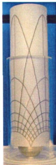
Figura 1.1 (a) Pantalla plana con la que se forma la pantalla cilíndrica. (b) Pantalla cilíndrica en la que se introduce la superficie de prueba.
