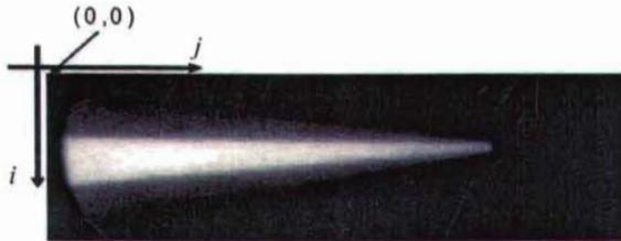
Figura 3.16. Imagen de la lámpara sobre el balín. La escala indica el número de píxel horizontal de la imagen.
