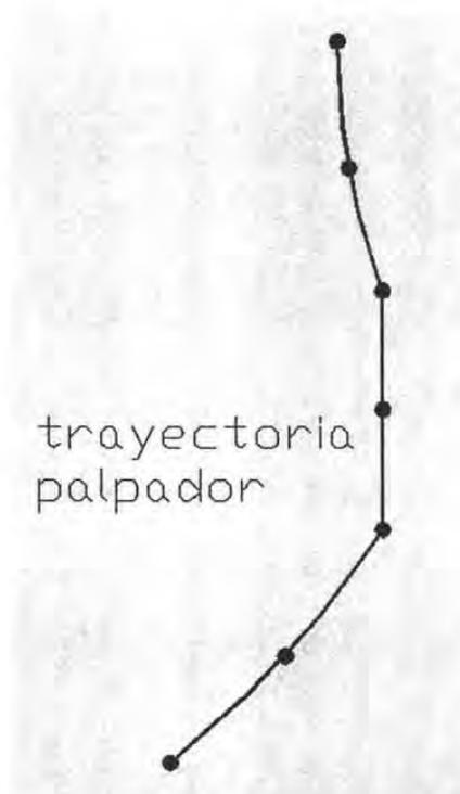
Figura 5.14. Colección de posiciones de palpador definiendo una trayectoria.
