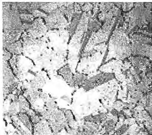
Fig. B1. Microestructura del primer bronce fabricado por medio del microscopio óptico. 40X.
