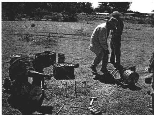
Figura 4.14. Arreglo del Dispositivo Schlumberger
