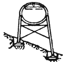
g) Acueducto cerrado de acero sobre caballetes
