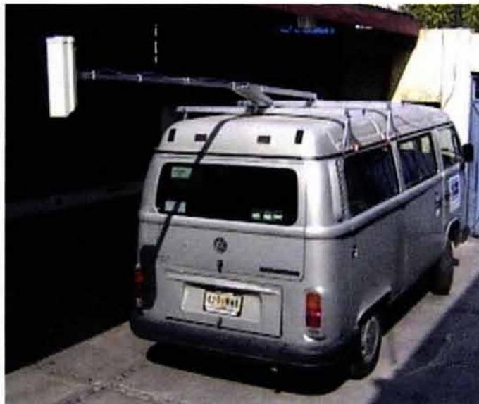
Foto 7.3 Equipo de video digital para determinar el deterioro superficial de pavimentos
