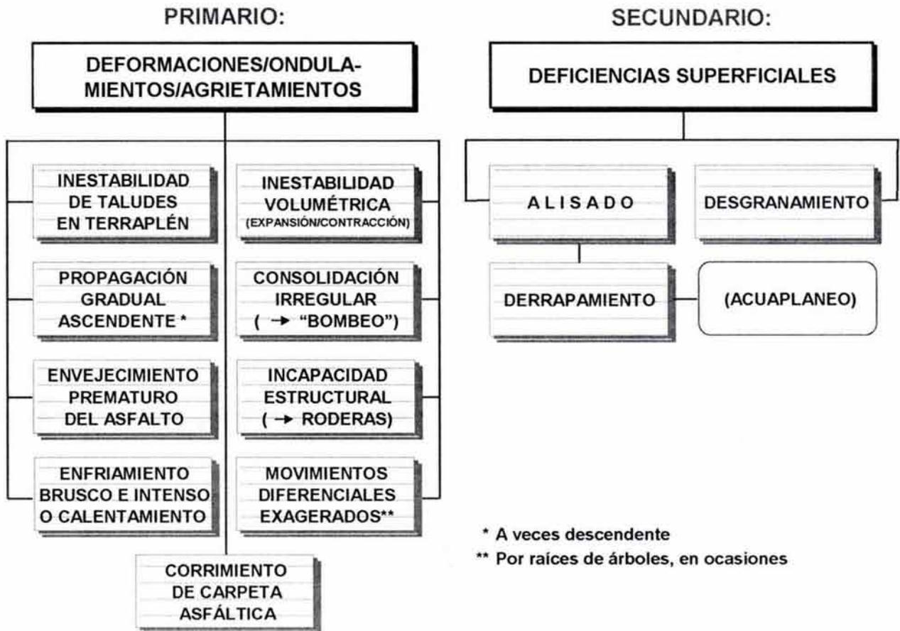
Figura 7.3 PRINCIPAL DETERIORO DEL PAVIMENTO
