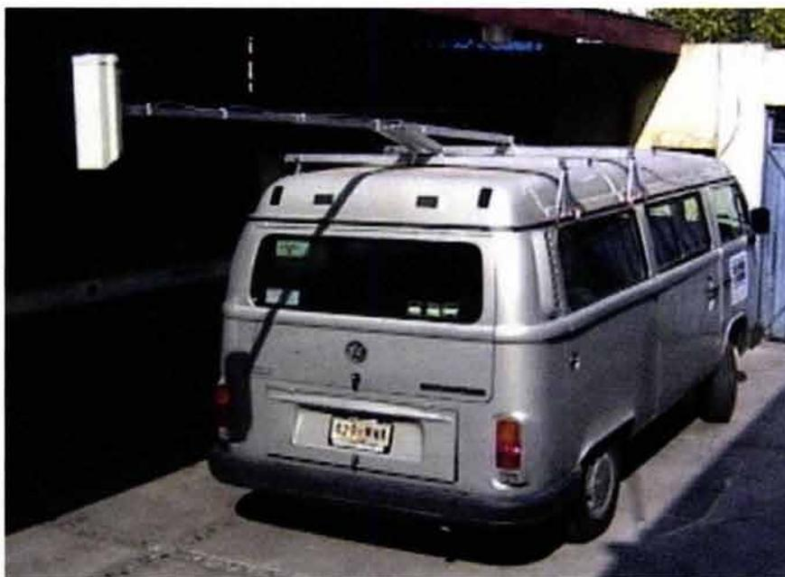
**Figura D.2** VEHÍCULO PARA LA MEDICIÓN AUTOMATIZADA DEL DETERIORO SUPERFICIAL, CON EL SISTEMA "uniSURVEY"
