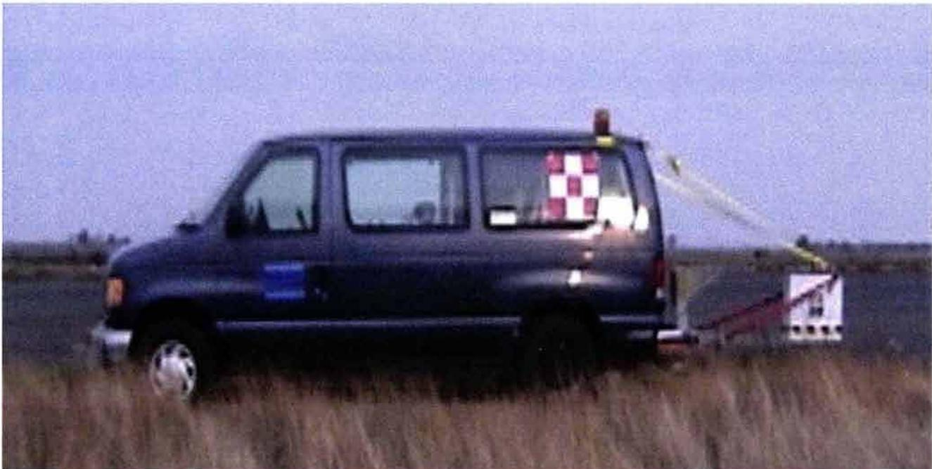
Figura C.1. FOTOGRAFÍA DEL EQUIPO GPR, EN LA QUE SE APRECIA LA ANTENA AÉREA FIJADA A LA DEFENSA TRASERA DEL VEHÍCULO DE MEDICIÓN (EIOCSA, 2003)
