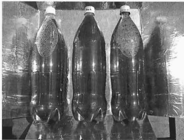
Figura 32. Botellas contenidas en el concentrador de cinta de aluminio
