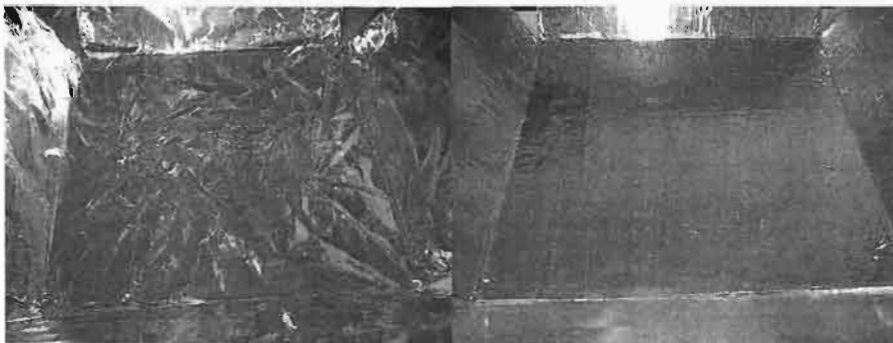
Figura 33. Comparación del plástico metalizado y la cinta de aluminio colocadas en el concentrador solar después de realizar las pruebas
