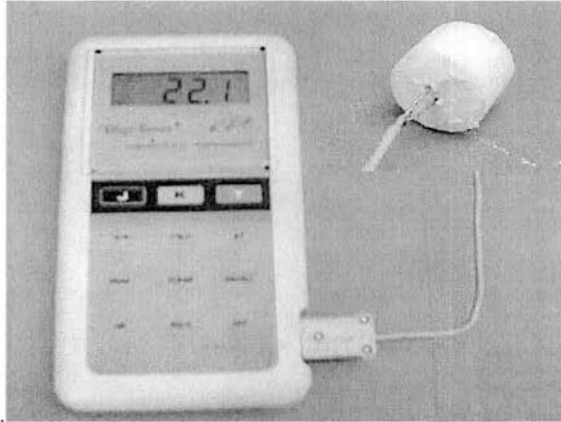
Figura 17. Termómetro digital y probeta empleados en el monitoreo de temperaturas de fraguado.
