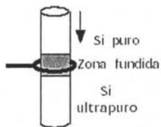
Figura 2.-Refinación por zonas de silicio.
