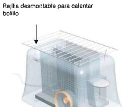
El tostador incluye una rejilla desmontable de acero inoxidable que se coloca en la parte superior para calentar bolillos o tortillas.
