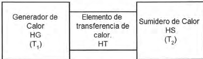
Figura 2.12. Esquema que explica el origen de la diferencia de temperatura en máquinas de diferente tamaño.
