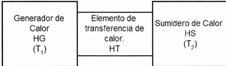
Figura 12. Esquema que explica el origen de la diferencia de temperatura en máquinas de diferente tamaño.
