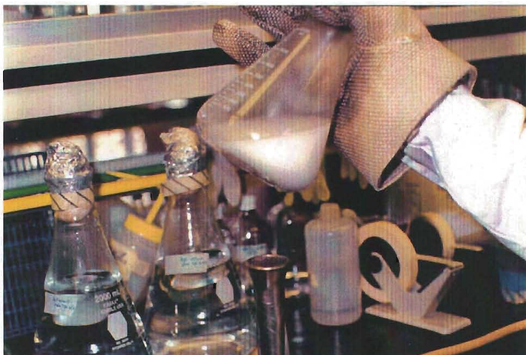
Figura 3. Ebullición de la suspensión de almidón para la preparación del gel.
