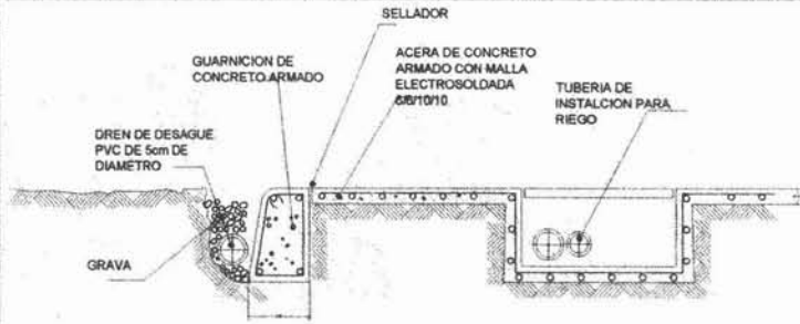
DETALLE DE INSTALACION PARA RIEGO
