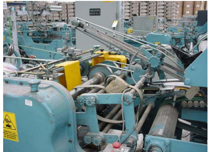
Fotografía 10. Prensado de Dobles con adhesivo
