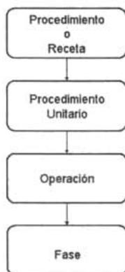
Figura 4.6 Los Cuatro Niveles del Modelo de Procedimientos
