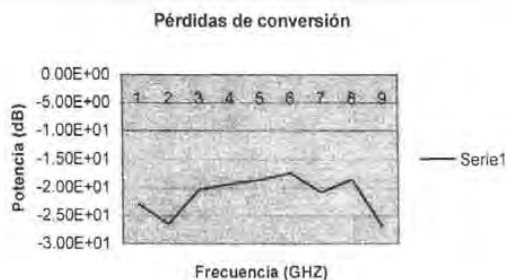
Fig. 38.- Gráfica de las pérdidas de conversión para diferentes frecuencias, para el arreglo de doblador de frecuencias que utiliza un circuito híbrido a la entrada, (Referencia: Programa de simulación Microwave Office).
