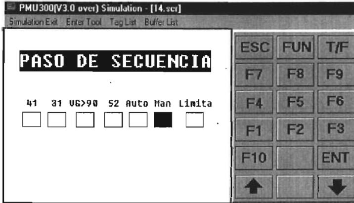
Esta pantalla es únicamente de visualización, permite al usuario saber en que condiciones de secuencia de arranque y paro se encuentra el regulador automático de voltaje (RAV).
