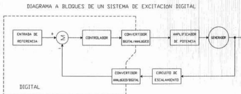
Los bloques dentro de la línea punteada son típicamente implementados por tecnología digital, en particular por uno o más microprocesadores. Los bloques de interfaz denominados A/D y D/A se utilizan para convertir las señales de analógicas a digitales y de digitales nuevamente a analógicas respectivamente.
