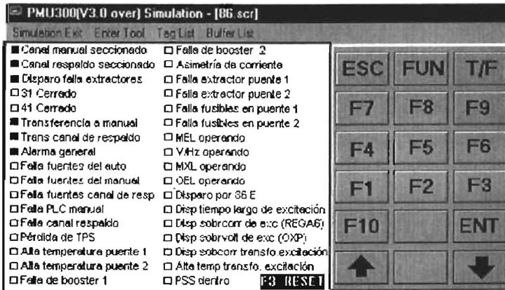
En esta pantalla el usuario puede visualizar el estado actual en el que se encuentran las alarmas del regulador automático de voltaje. Para poder visualizar la segunda pantalla de alarmas, se debe pulsar el botón que tiene la flecha hacia abajo, apareciendo la **Pantalla Alarmas2** que se muestra a continuación:
