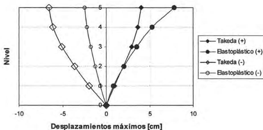
**Figura 7.1** Desplazamientos de la estructura original con el sismo El Centro 1940
