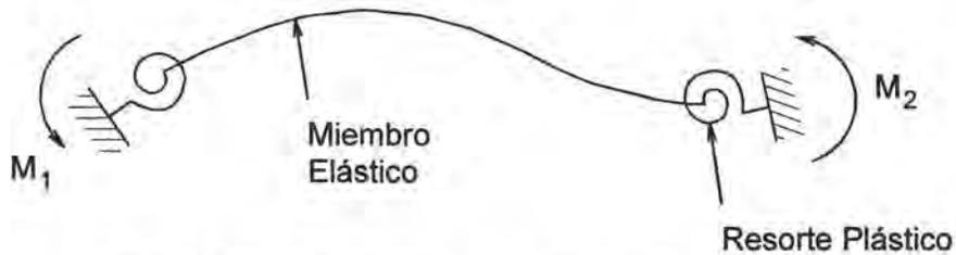
**Figura 4.3** Modelo viga de un componente de Giberson
