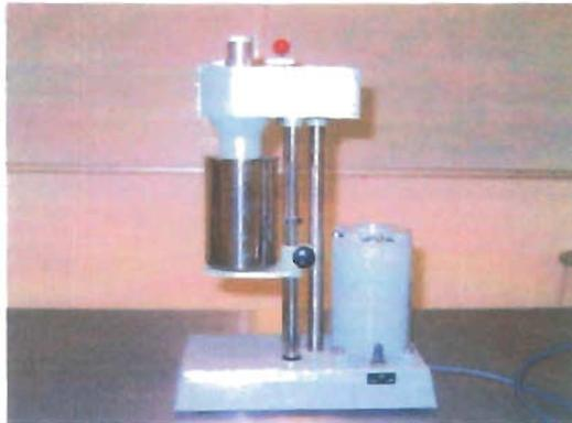
Figura III.5 Viscosímetro rotacional fann 35-A
